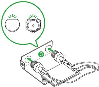
Richten Sie die flache Seite des RF-Anschlusses an der flachen Seite der Öffnung in der M.2 Key E Halterung aus, wie in der Abbildung gezeigt, und schieben Sie den Anschluss dann fest in die Öffnung.
