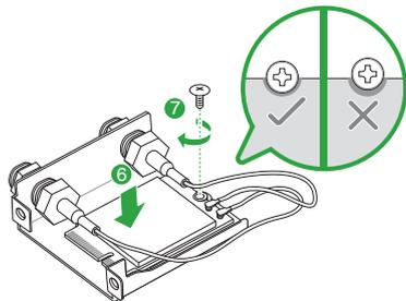
Richten Sie die Einkerbung an der WLAN-Karte dicht am Schraubenloch aus.
