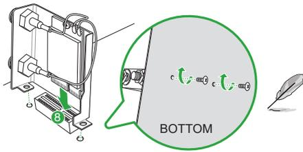
Setzen Sie die WLAN-Karte in den M.2 Key E Steckplatz ein und befestigen Sie dann das Modul an der Unterseite des Motherboards mit Schrauben.
