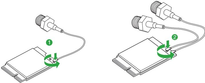
Stellen Sie sicher, dass der IPEX-Anschluss des RF-Koaxialkabels fest mit der WLAN-Karte verbunden ist.
